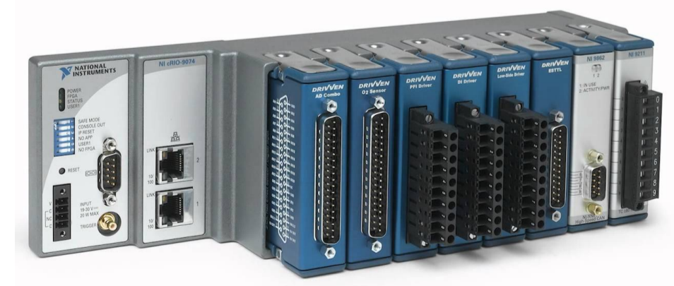
Щит National Instruments (Data Acquisition System) с установленным на него модулем CAN
